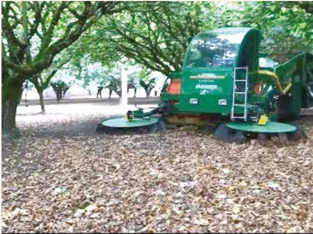
Şekil 3. Pnömatik ve mekanik etkili fındık toplama makinelerinin genel görünüşü.
