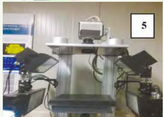
Şekil 1. Klorofil Floresan Ölçüm Sistemi: 1) Frekans ölçüm cihazı, 2) Klorofil floresan ayırma cihazı, 3) Bilgisayara veri aktarımı, 4) Klorofil floresan ölçüm grafiği, 5) Klorofil floresan ölçümüne.
