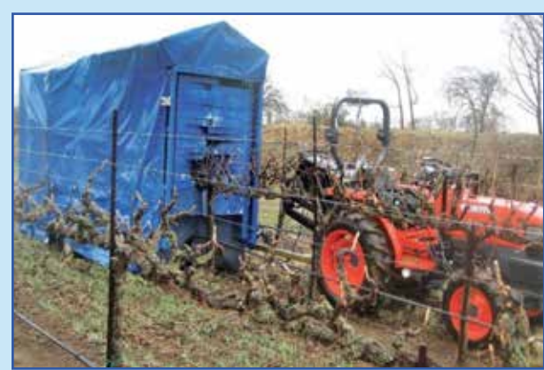
Şekil 5. Bağlarda Kış Budaması için Geliştirilen Budama Robotu.
