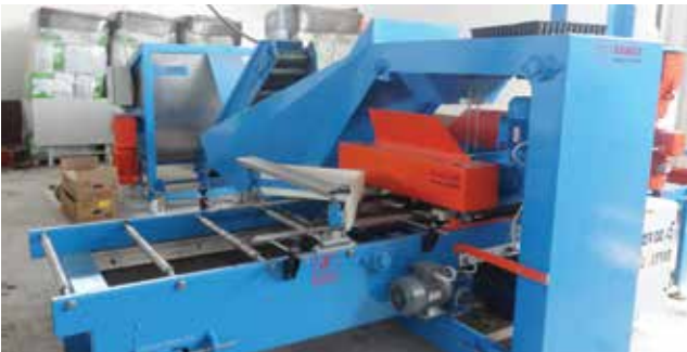
Şekil 4. Hazır Fide Yetiştiriciliğinde Kullanılan Özel Tohum Ekim Makinası
